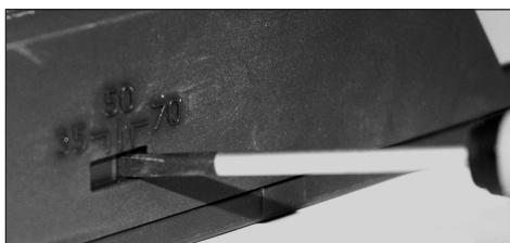
**Let op:** Via de schakelaar aan de zijkant van het apparaat kan de wattage worden ingesteld. Zorg ervoor dat de instelling overeenkomt met de gebruikte lampen. Het verwisselen van de wattages is alleen toegestaan wanneer de stekker uit het stopcontact is gehaald!
