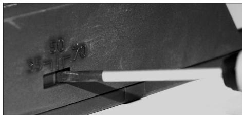
Tenga en cuenta: A través del interruptor en el lado del aparato se puede ajustar la potencia. Asegúrese de que el ajuste coincida con el alumbrado utilizado. ¡El cambio de potencia sólo se permite con el enchufe de red desconectado!
