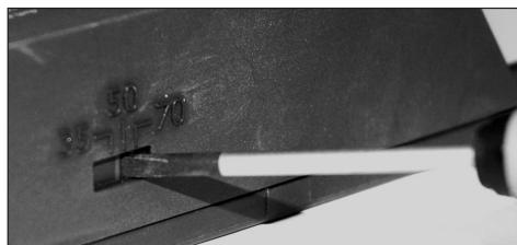
**Achtung:** Über den Schalter an der Seite des Geräts kann die Wattage eingestellt werden. Achten Sie darauf, dass die Einstellung mit dem verwendeten Leuchtmittel übereinstimmt. Der Wechsel der Wattagen darf nur bei gezogenem Netzstecker erfolgen!
